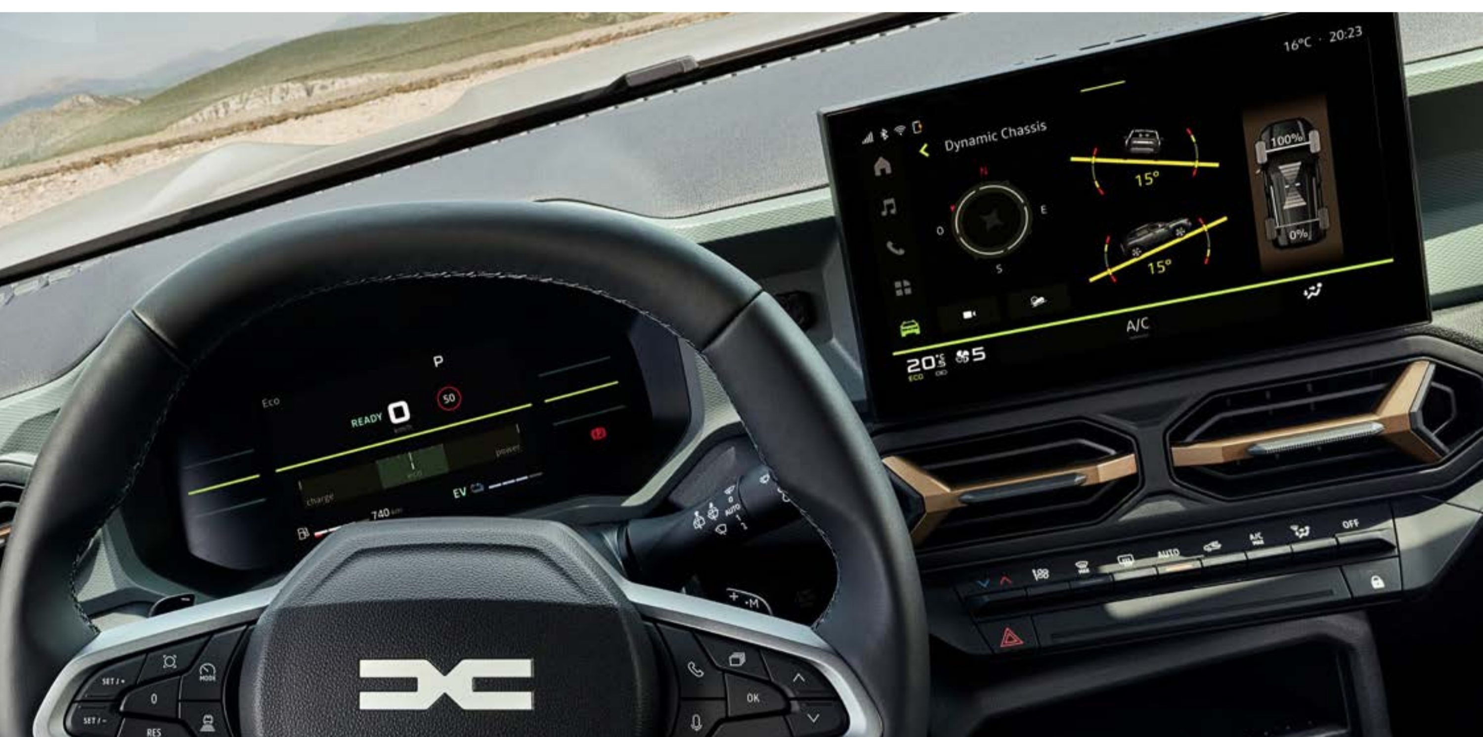
Pekskärm med 4x4 information: lutningsvinkel och kraftfördelning
