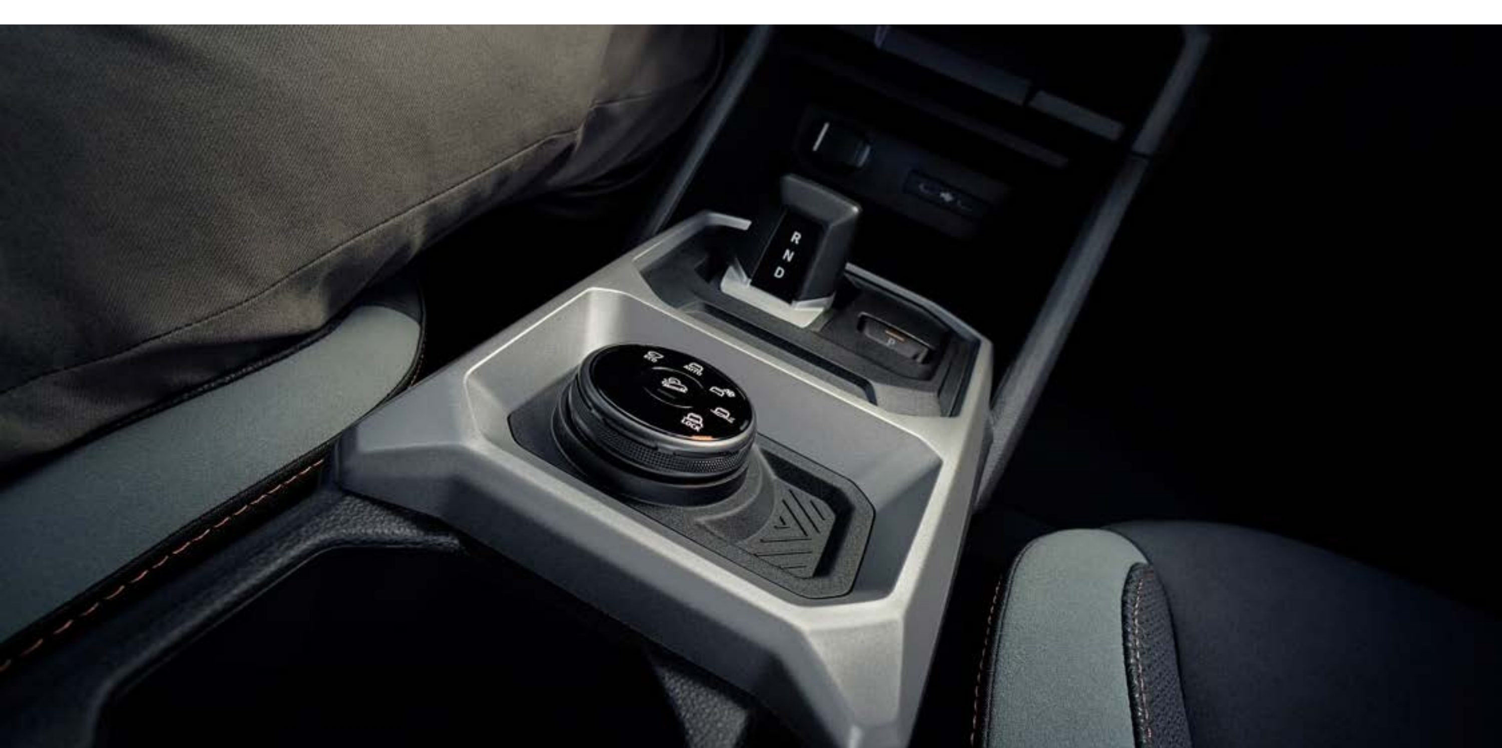
6-växlad automatväxellåda och körprogramsväljare
